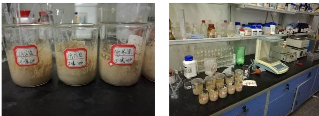
图 6.3-3 汞污染土壤修复实验室小试研究
